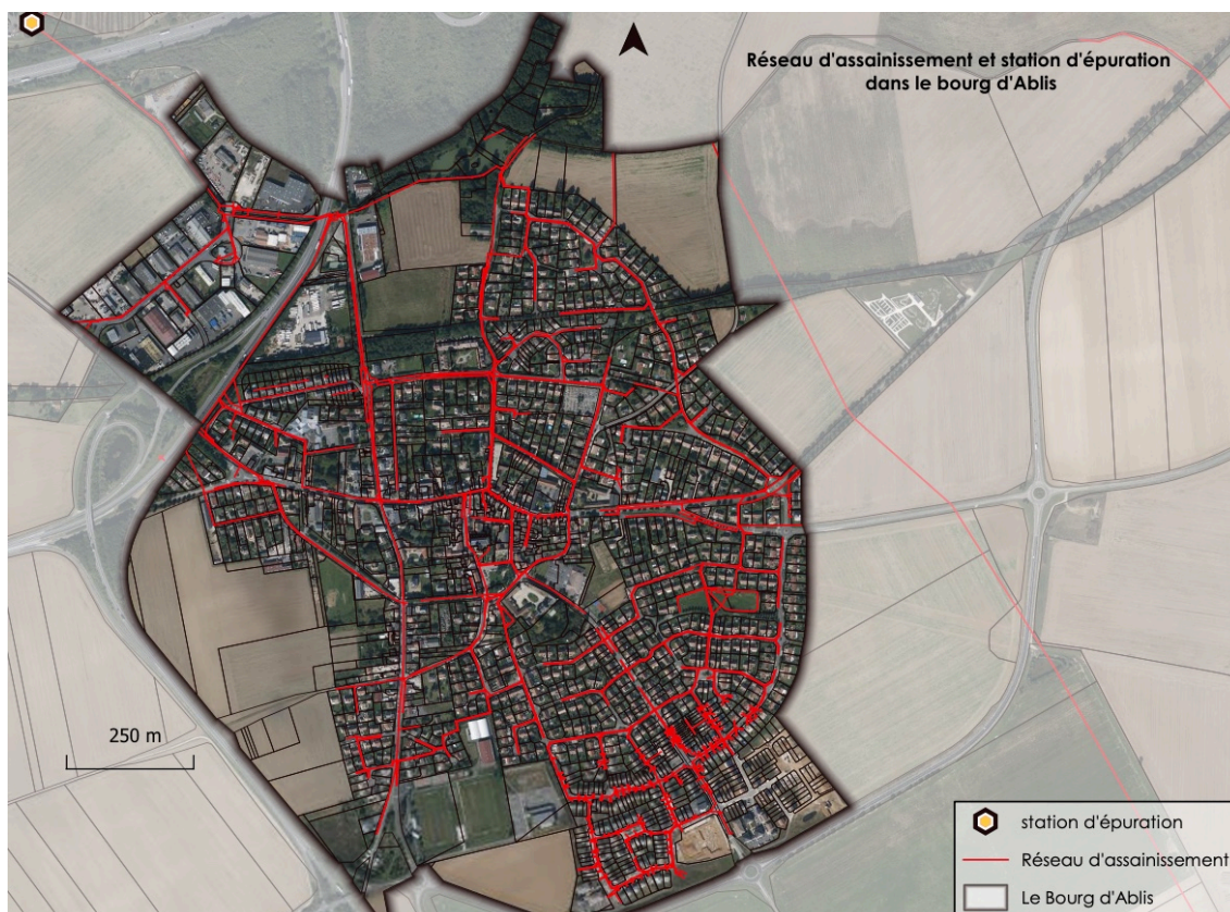
RÉSEAU D'EAUX USÉES DU BOURG D'ABLIS
